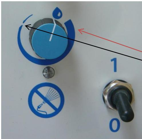
Die Breikonsistenz wird durch den Drehknopf (siehe Bild) eingestellt. Der Wassertropf steht für Wasser ohne Futteraustragung.
